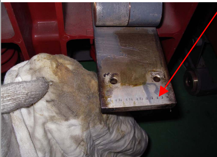
5) VCB CONTACTOR 고착그리스 소제 후의 상태
