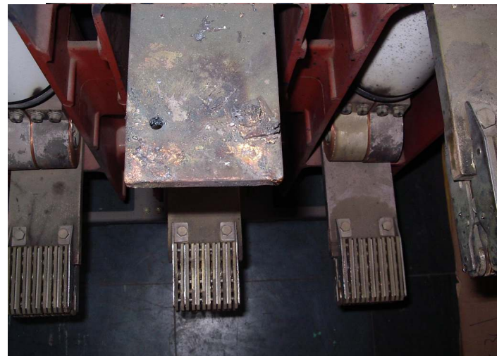
6) VCB 접촉자 접촉 불량으로 사고 발생 상태(용착)
