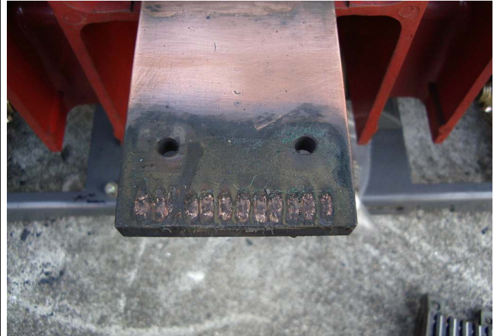
2)CONTACTOR에 그리스가 먼지와 함께 고착된 상태
