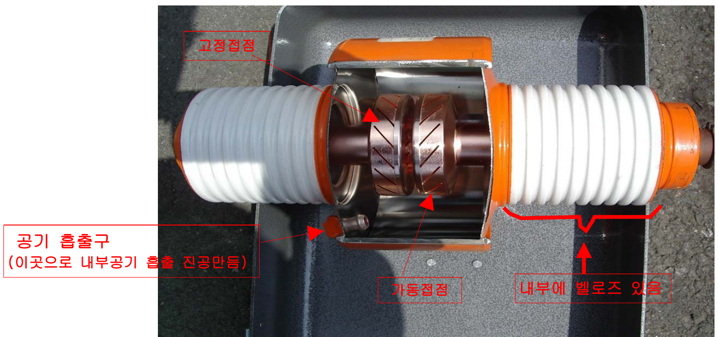
↑ 진공발브 모델(현대중공업 24KV 1200A 25KA)
